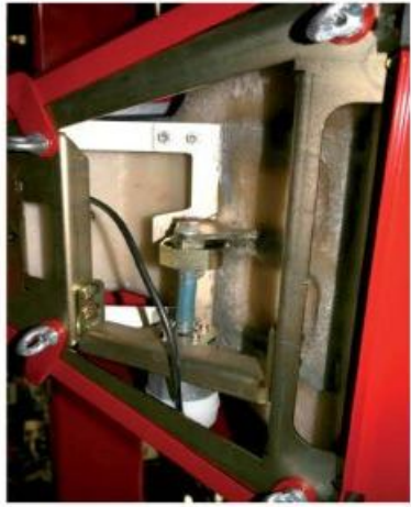
Фото 4. Вибрирующий механизм установки отвода
