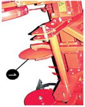
Фото 6. Грейдеризующая фреза с копировальным диском
