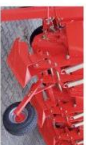
Фото 3. Сошкины для каменистых почв с копирующим колесом
