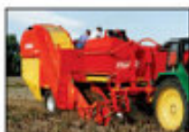
SE 75-20/30/40: карто- фелеуборочный комбайн однорядный, с боковым подкопом, с бункером 2, 3 или 4 тонны
