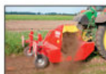
KP 1700: ботвоудалитель для моркови и столовой свеклы с системой QUICK-FIX для быстрой смены бичей
