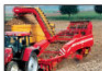
GT 170: двухрядный, с центральной подкопом, картофелеуборочный комбайн с элеватором
