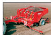
GL 30 T-серия: полунавесная картофелесажалка, 4-х, 6-ти, 8-ми или 12-ти рядная
