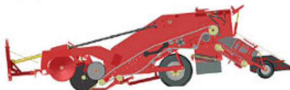
Рис.9. Прицепной картофелекопатель WR 200.2
