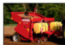
GL 40 T-серия: ременная картофелесажалка, 4-х рядная
