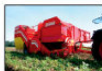
SE 75/85-55: картофелеуборочный комбайн однорядный, с боковым подкопом и бункером 5,5 тонн
