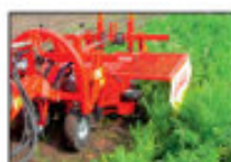
BK 1700: дорезчик ботвы для овощей в грядке с четырьмя регулируемыми опорными колёсами
