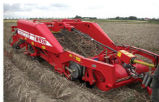
Рис.5. Прицепной картофелекопатель WR 200
