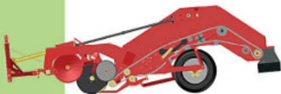
Рис.7. Прицепной картофелекопатель WR 200.1
