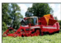
TECTRON 415: самоходный, 4-х рядный, с центральной подкопом, картофелеуборочный комбайн мощностью в 335 кВт/456 л.с.
