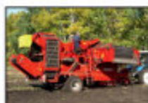
DR 1500/BR 150: комбайн двухрядный, с центральной подкопом и бункером 4,5 тонн
