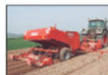
Комбинация 5e1: картофелесажалка в комбинации с фрезой, 4-х рядная
