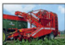
Rootster 604: прицепной, с 6 м³ бункером, свеклоуборочный комбайн с элеватором, 6-ти рядный
