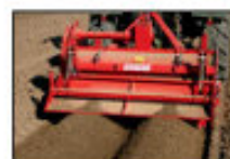
GF-серия: гребнеобразующая фреза, двухрядная
