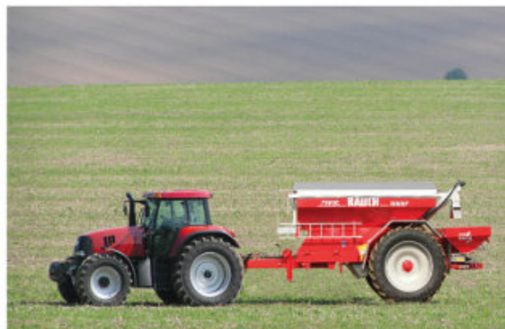
Разбрасыватель удобрений для больших площадей: TWS 7000: рабочая ширина от 10 до 42 метров, макс. вместимость 8.500 кг
