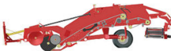
Рис.12. Прицепной картофелекопатель WR 200.4
