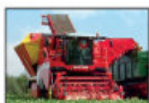
MAXTRON 620: самходный комбайн, 6-ти рядный, 22-х тонный бункер с инновационной концепцией подкалывающих устройств и ходовой части
