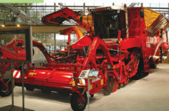
Рис.2. Самоходный картофелеуборочный 4х рядный комбайн Testron
