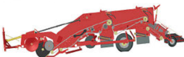
Рис.10. Прицепной картофелекопатель WR 200.3
