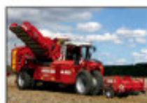
VARITRON 270: самоходный, 2-х рядный, с боковым подкопом, комбайн с 7-ти тонным бункером и 240 кВт/326 л.с.
