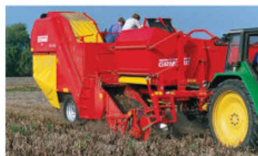
Рис.3. Однорядный картофелеуборочный комбайн с боковым подкопом SE 75-30
