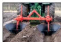
BF 200: грядообразователь для одной гряды
