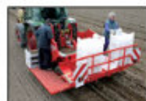
GL 34 RB: картофелесажалка для пророщенного картофеля, 2-х или 4-х рядная
