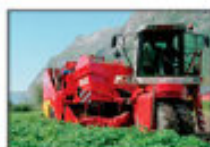
SF 150/170-60: самоходный, 2-х рядный, с боковым подкопом, комбайн с 6-ти или 7,5-ти тонным бункером и мощностью в 205 кВт/280 л.с.
