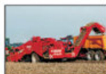
GV 3000: 4-х рядный, с центральной подкопом, картофелеуборочный комбайн с элеватором
