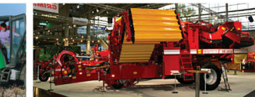
Рис.4. Двухрядный картофелеуборочный комбайн SE 150-60, с разгрузкой «на ходу»
