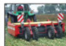
BM 300/330: высокопроизво- дительный ботвоудалитель, 6-ти рядный
