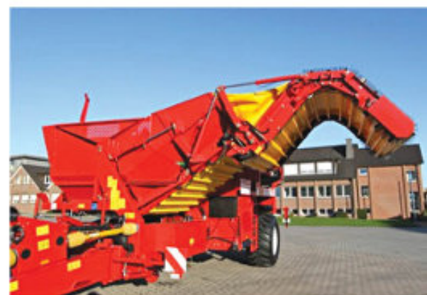
Рис.6. SE 150-60, бункер с дополнительным транспортером
