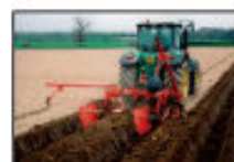
BFL 200: грядообразователь для одной гряды, с удлинёнными корпусами
