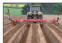
BFL 600: грядообразователь для 3-х гряд, с удлинёнными корпусами
