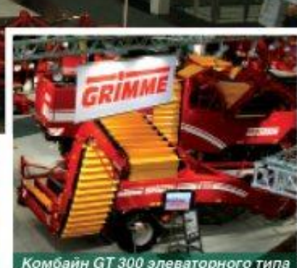
Комбайн GT 300 элеваторного типа
