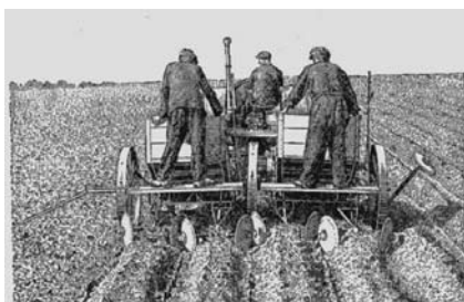
Рис. 2.4. Картофелесажалка КС в работе. Слева – при гребнистой посадке, справа – при гладкой посадке.
