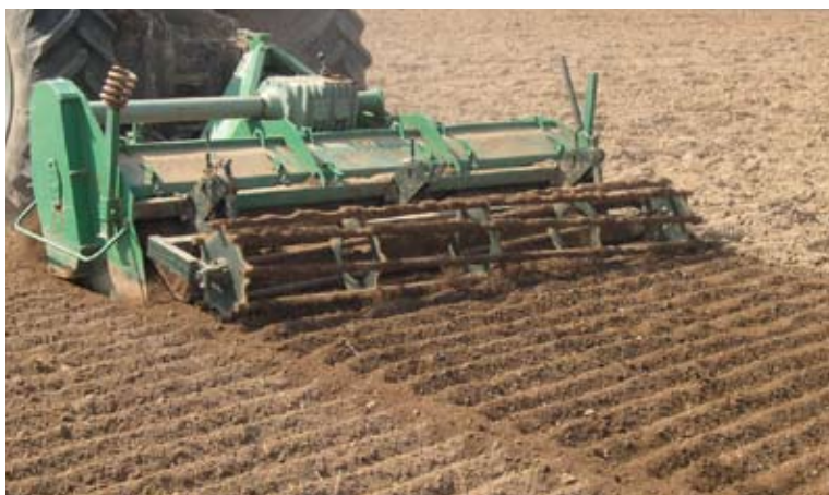
Рис. 4.3. Фрезерный культиватор RSF 2000 для сплошной обработки почвы.
