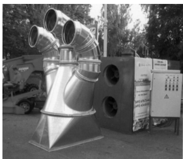
Рис. 13.14. Модульная установка кондиционирования воздуха «МикроКлимат-М» для хранилищ контейнерного (а) и навалного (б) типов.
