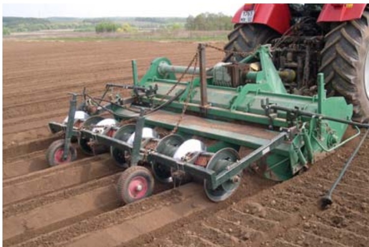
Рис. 4.4.б. Культиватор-гребнеобразователь RSF 2000–I с валом для сплошной обработки и с роликовыми грядообразующими устройствами на подготовке гряд для посева овощных культур.
