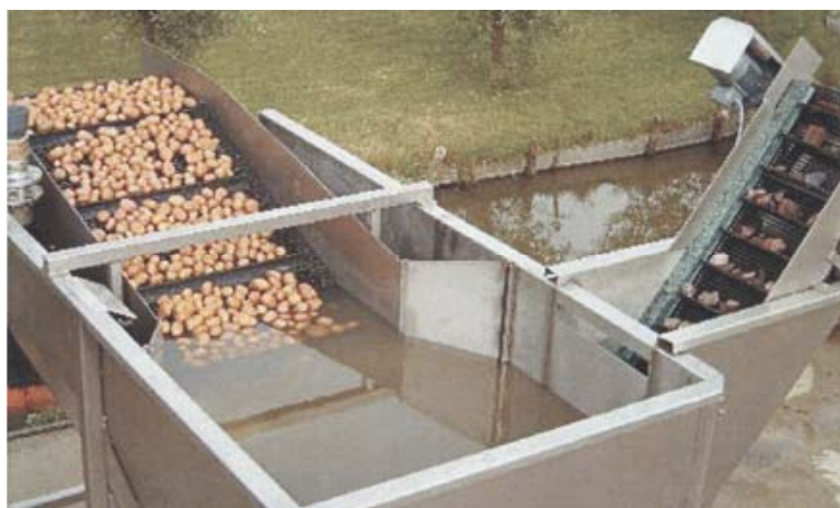
Рис 12.19. Передвижной отделитель картофеля от примесей в воде производительностью 20–40 т/ч фирмы Botman (Нидерланды).
