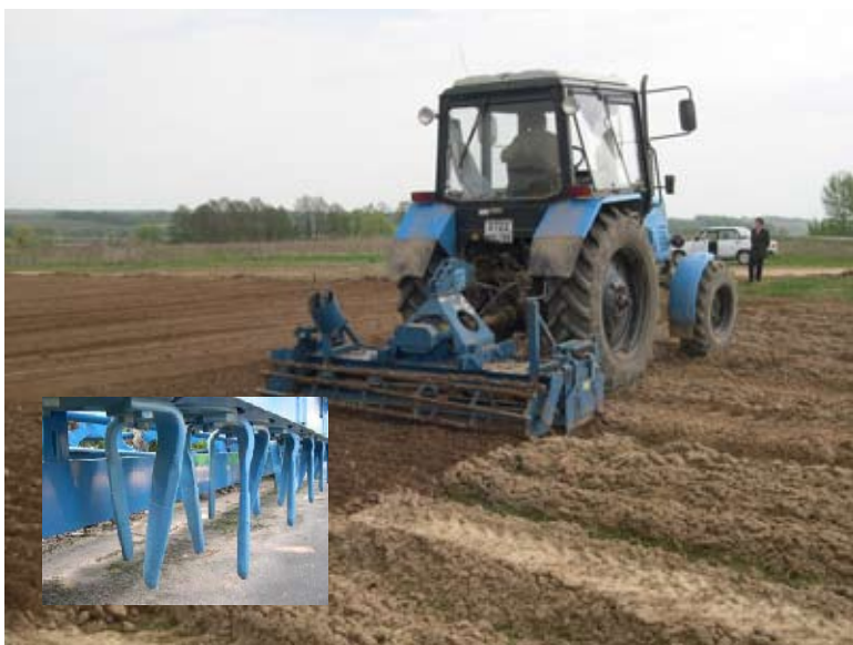
Рис. 4.2. Культиватор вертикально-фрезерный РКЕ 300 на предпосадочной подготовке почвы (вверху) и его рабочие органы (снизу).
