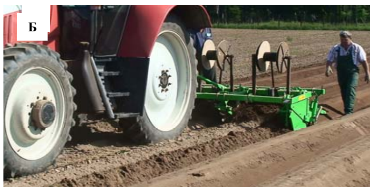
Рис. 9.8. Культиватор–гребнеобразователь фрезерный RSF 2000 (а) и культиватор-окучник КГП 4 (б) с приспособлениями для укладки систем капельного орошения.
