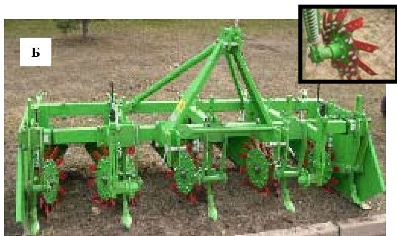
Рис. 9.6. Культиватор-окучник КГП 4х(70–90) производства ЗАО «КОЛНАГ»: а – машина в работе; б – пассивные рабочие органы культиватора, в – почвоприводной ротор.
