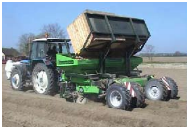
Рис. 8.2. Картофелесажалка со специальной площадкой для установки контейнеров с семенным картофелем и их разгрузки во время посадки
