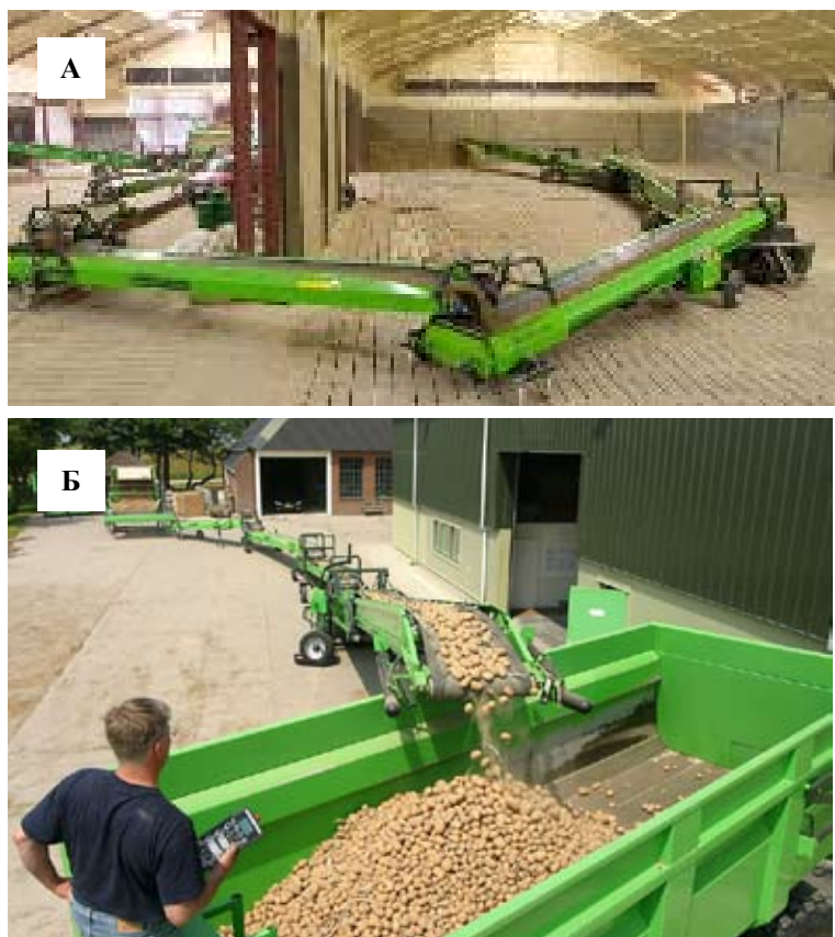
Рис. 12.13. Система многофункциональных ленточных конвейеров (ТАТ–НАТ) различных типов. а – установка в хранилище, б – работа в загрузочном комплексе.
