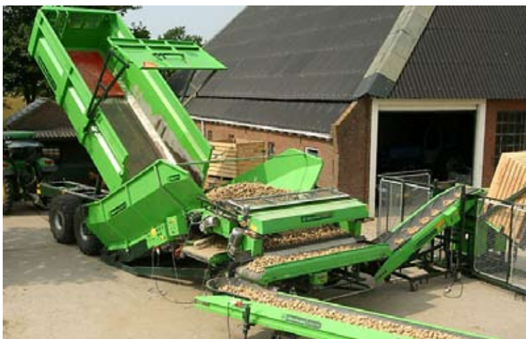
Рис. 12.3. Закладка картофеля в хранилище навалного типа по прямоточной технологии «поле–хранилище» с минимальной доработкой.
