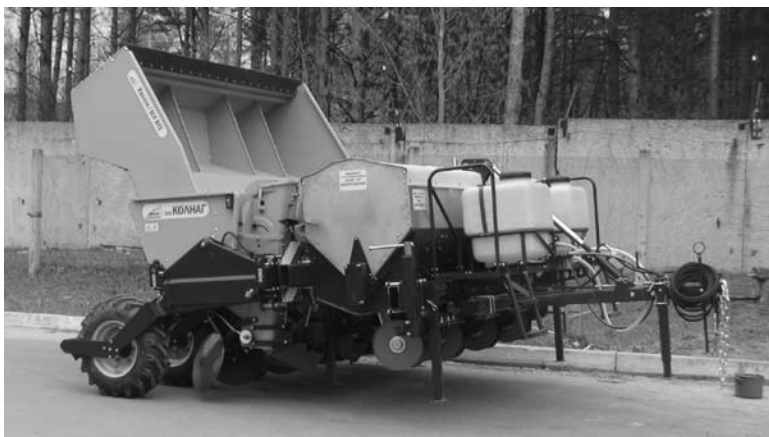
Рис. 8.3. Сажалка HASSIA SL 4 BZS с комплектами приспособлений для локального внесения минеральных удобрений и для опрыскивания клубней защитно–стимулирующими веществами в борозде.
