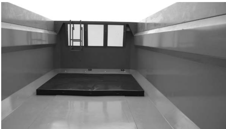
Рис. 14.3. Амортизирующая плита в кузове транспортного средства.
