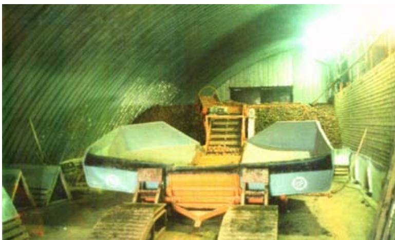
Рис. 12.6. Транспортёр–загрузчик ТЗК 60/30 (Россия) на загрузке картофеля в хранилище навалного типа, приёмный бункер раскрыт.
