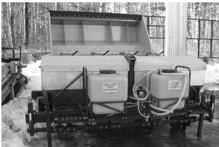
Рис. 10.1. Комплекты приспособлений к сажалке Hassia SL 4 BZS для внесения минеральных удобрений и для опрыскивания клубней защитно-стимулирующими веществами при посадке.
